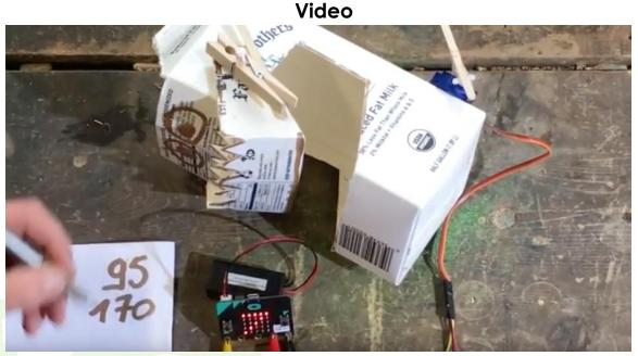
Usa este programa para calibrar los ángulos de un servo. Presione A para reducir el ángulo en 5 y B para aumentarlo en 5. El ángulo actual se muestra en la pantalla en un bucle.
